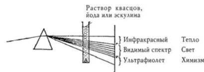
Рис. 17. Три части спектра: тепло, свет и химизм. В зависимости от содержимого сосуда А поглощается одна из частей спектра, а именно: - посредством раствора квасцов - тепло (инфра-красный). - посредством раствора йода - свет (видимый спектр). - посредством раствора аскуллина - химизм (ультрафиолет)
